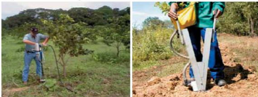
Figura 17. Lanza de inyección y compresor. Revista Actualidad del Campo Agropecuario 2013. Disponible en la página web: http://issuu.com/adca/docs/campo_149_noviembre13
