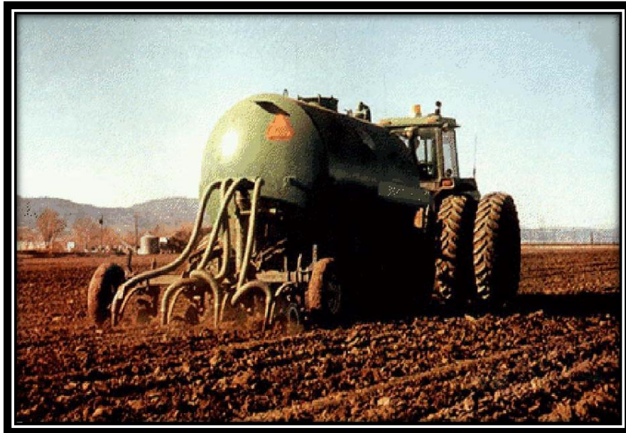
Figura 2. Tractor equipado con sistema de inyección de lodos (Pissani y Guzmán, 1999).
