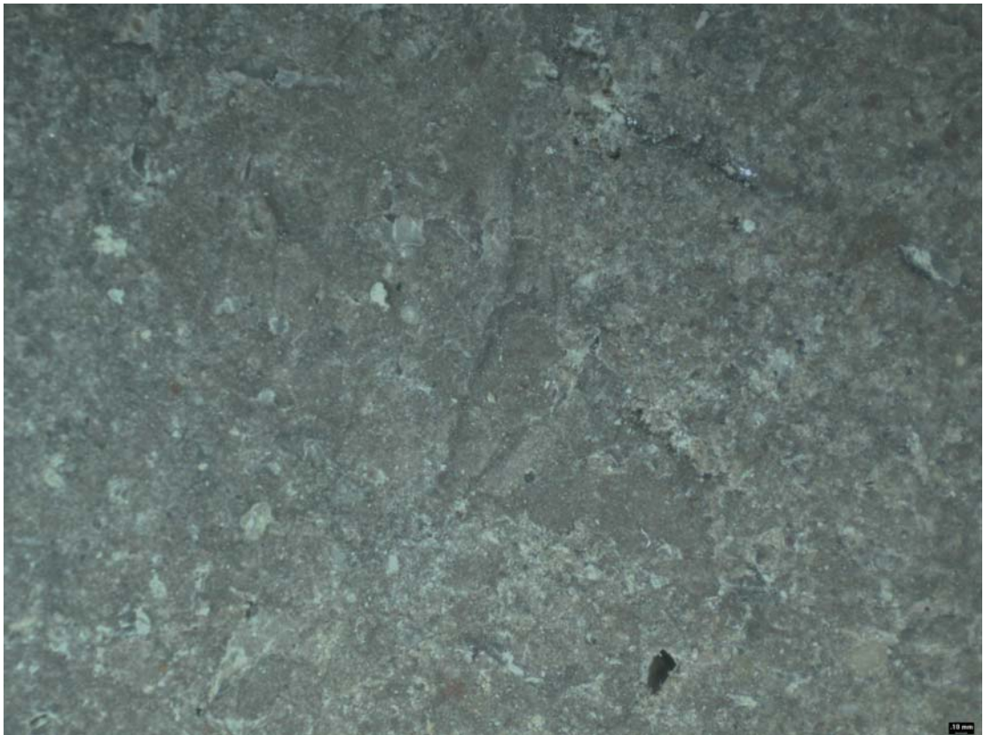
Figura 9. Imagen nivel estructural (16x) de un suelo limo-arcilloso, con la adición de 4\text{ml.litro}^{-1} de agua de ácidos húmicos de leonardita experimentales.
