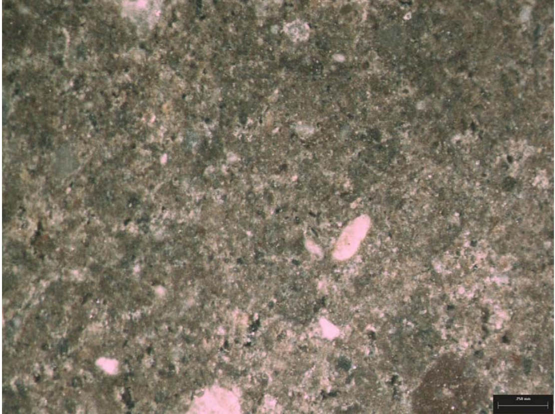
Figura 22. Imagen del nivel porosidad (50x) de un suelo limo-arcilloso con la adición de agua.
