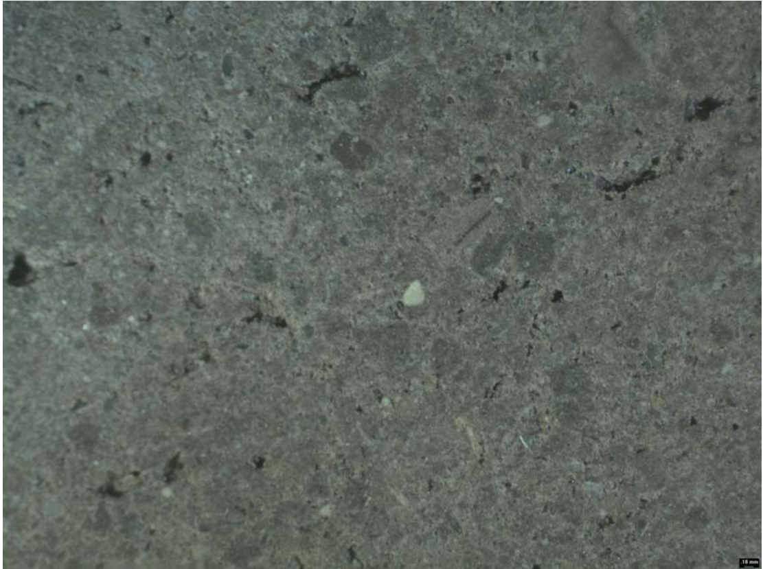
Figura 17. Imagen del nivel estructural (16x) de un suelo limo-arcilloso con la adición 6\text{ml.litro}^{-1} de agua de ácidos húmicos comerciales.
