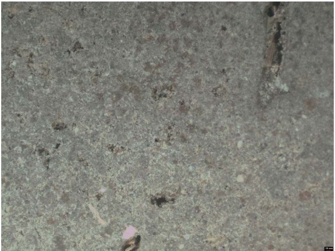
Figura 21. Imagen de nivel estructural (16x) de un suelo limo-arcilloso con la adición de agua.
