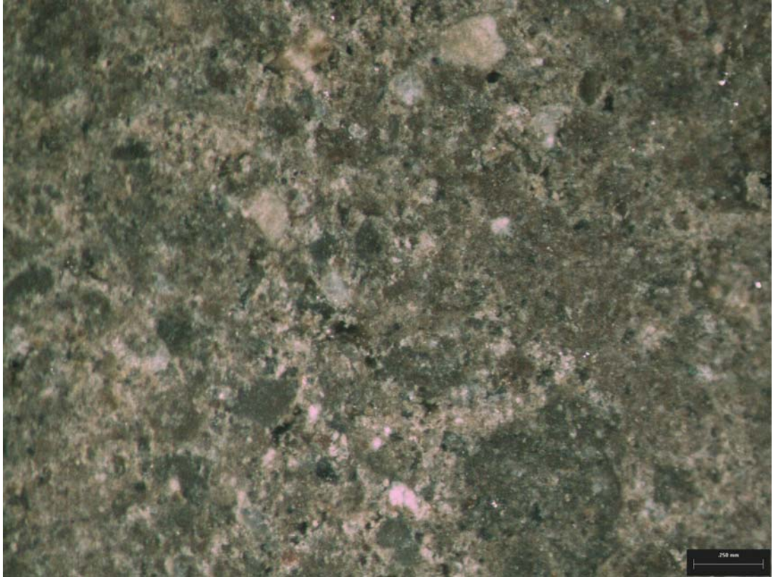
Figura 18. Imagen del nivel porosidad (50x) de un suelo limo-arcilloso con la adición de 6\text{ml.litro}^{-1} de agua de ácidos húmicos comerciales.
