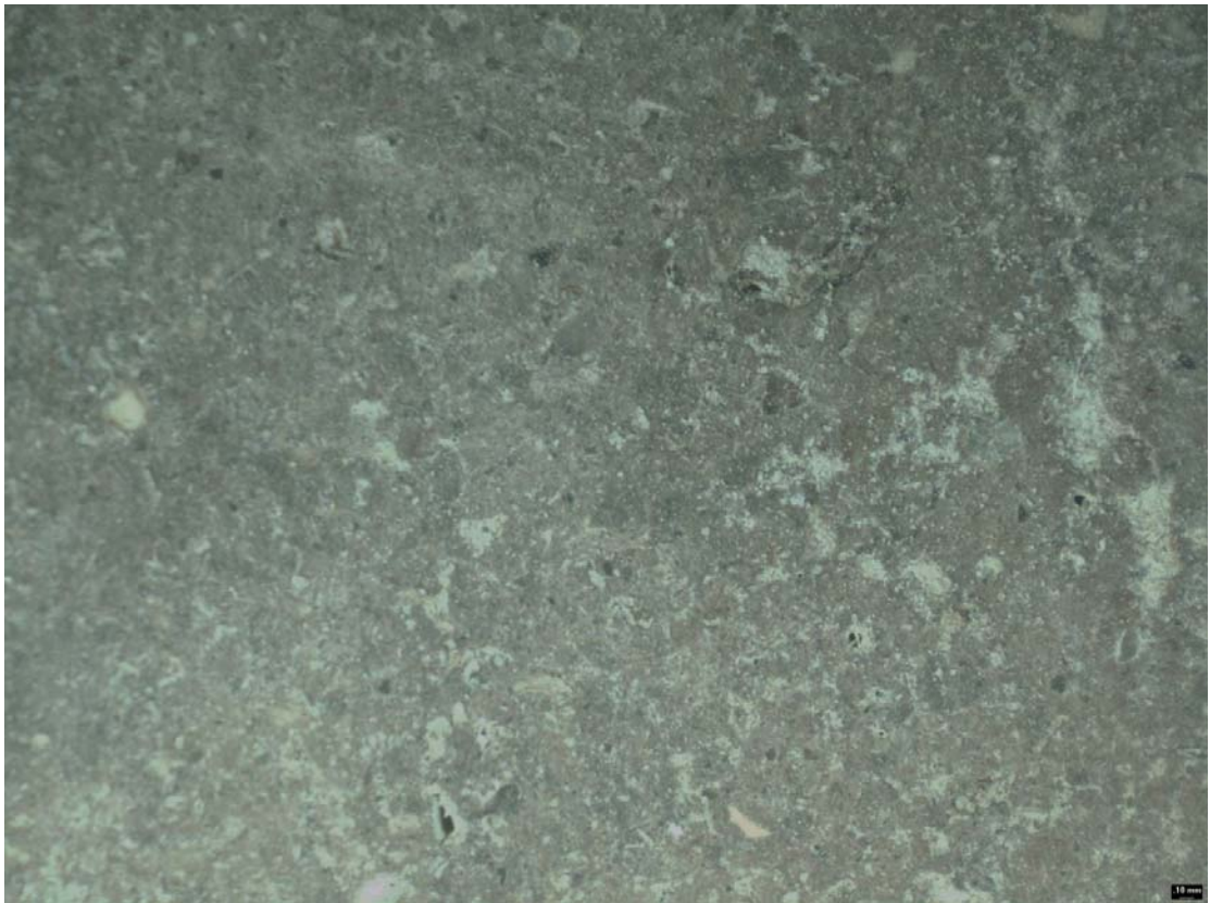
Figura 7. Imagen de nivel estructural (16x) de un suelo limo-arcilloso con la adición de 2\text{ml.litro}^{-1} de agua de ácidos húmicos de leonardita experimentales.
