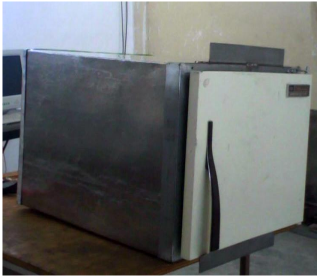
Figura 13. Refrigerador ecológico hecho de acero inoxidable calibre 22.
