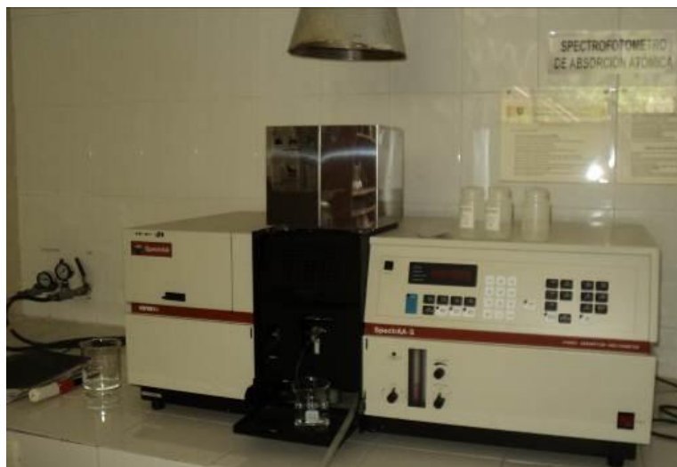
Figura 13. Espectrofotómetro de adsorción atómica, utilizado para determinar los micro elementos (Fe, Cu y Zn).
