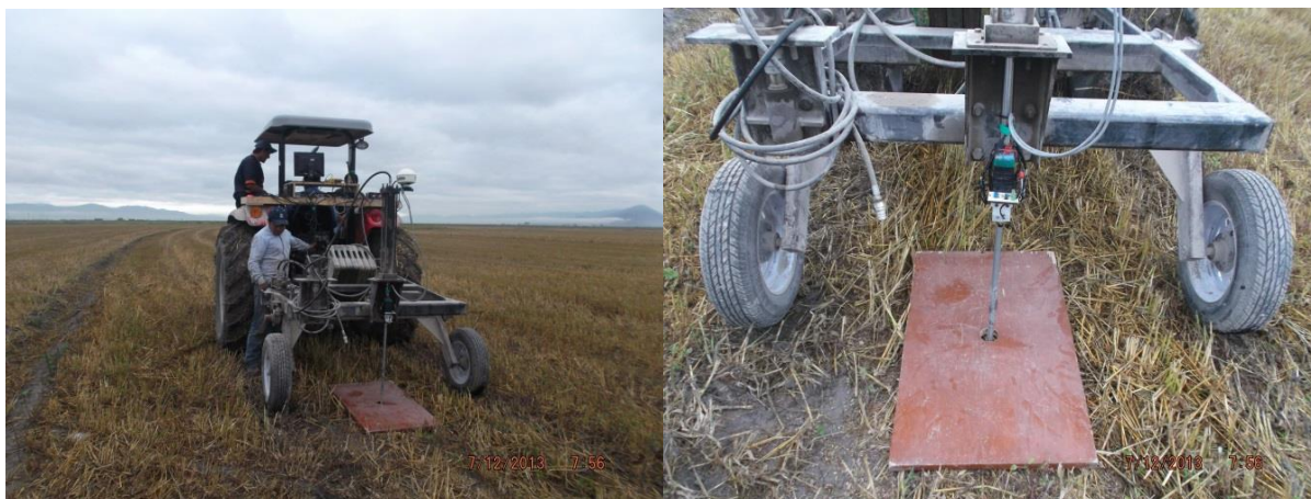
Figura 6.13 Evaluación con los sensores y circuito AD620 como filtro
