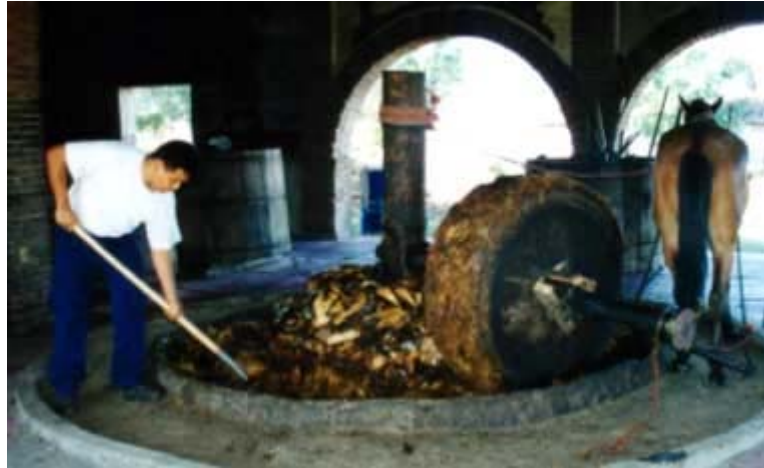
Figura 4: Acomodando los trozos de “piña” al centro del molino.
