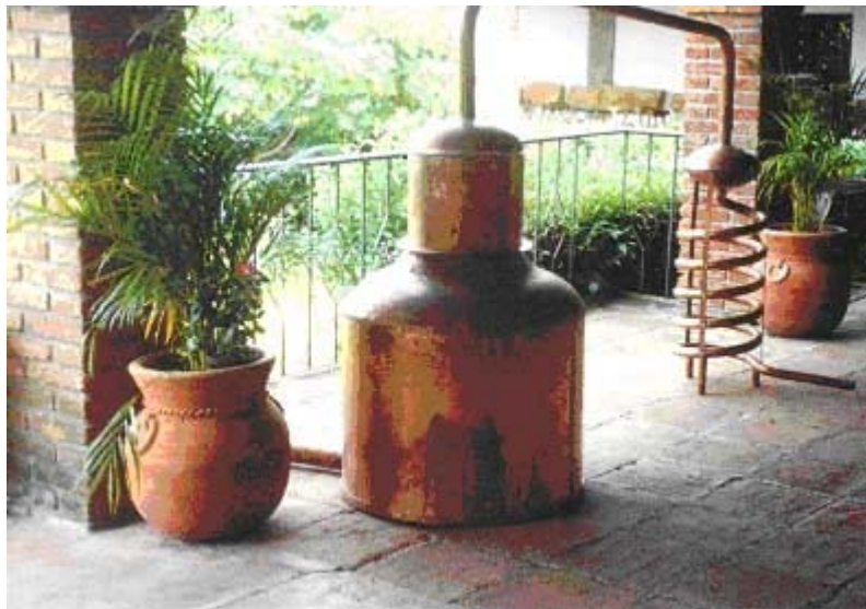
Figura 7: Campana y serpentín del alambique
