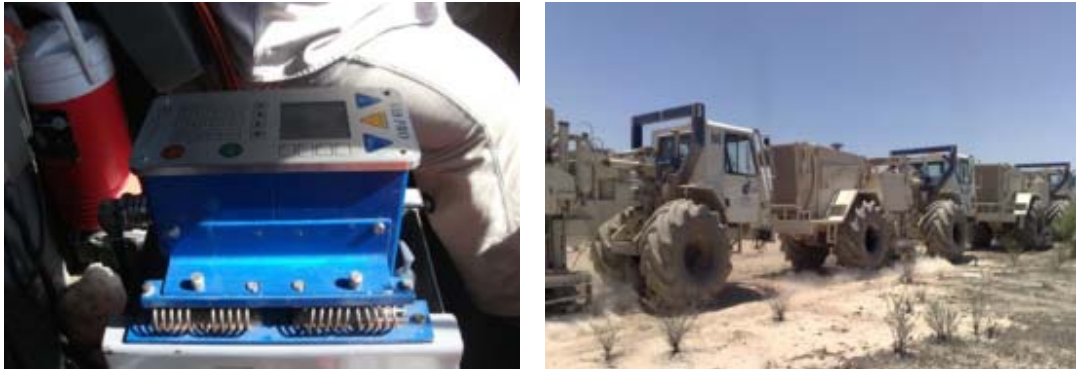
Vibrador marca IVI y controlador electrónico VIB PRO.
