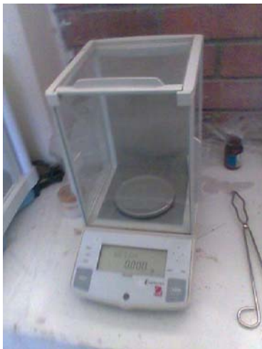
Figuras 19 y 20. Para analizar las muestras en laboratorio, primero se pesaba el recipiente vacío y después se taraba la báscula con el mismo.
