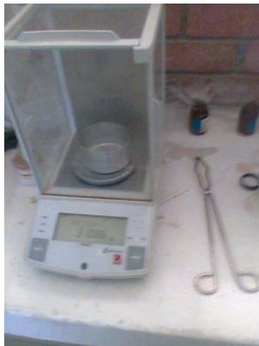
Figuras 19 y 20. Para analizar las muestras en laboratorio, primero se pesaba el recipiente vacío y después se taraba la báscula con el mismo.
