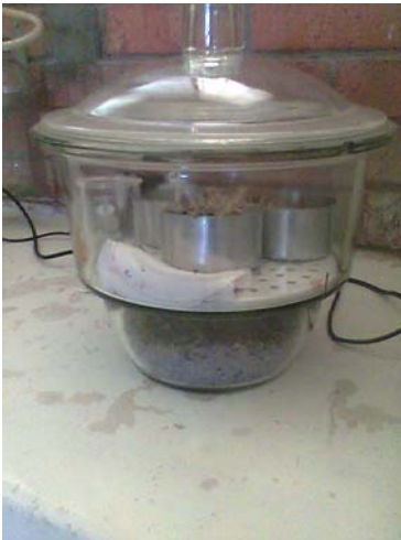
Figuras 25 y 26. Al día siguiente se retiraban de la estufa y se colocaban en un desecador por 1 hora.
