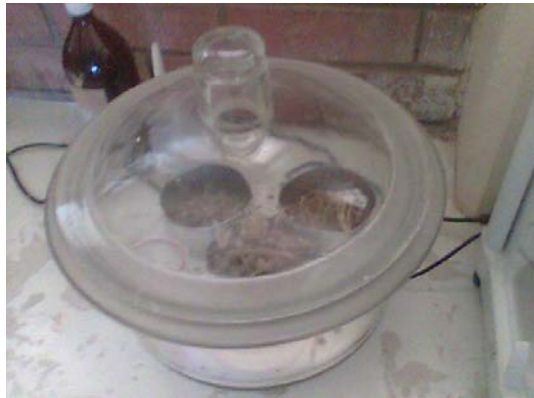
Figuras 25 y 26. Al día siguiente se retiraban de la estufa y se colocaban en un desecador por 1 hora.
