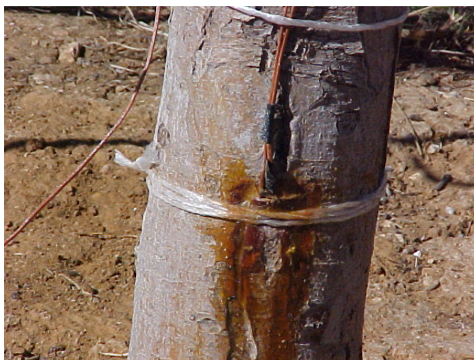
Figura 3.4. Inserción de termopares (cobre-constantan) en el tronco, lado sur del tratamiento control.
