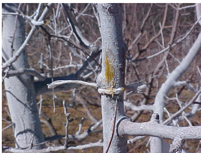
Figura 3.3. Inserción de termopares (cobre-constantan) en las ramas del tratamiento encalado.
