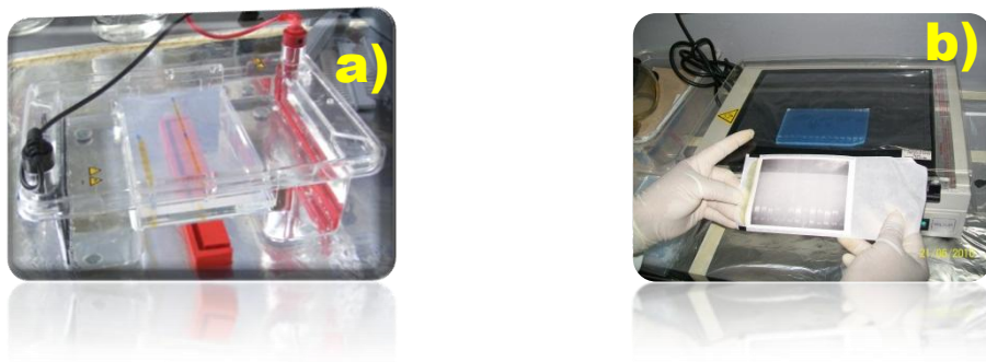
Figura 3.9. Muestra la técnica de electroforesis horizontal. a) muestras de ADN corridas durante la electroforesis, b) observación de bandas en el gel de agarosa utilizando el transiluminador y fotografía del mismo.
