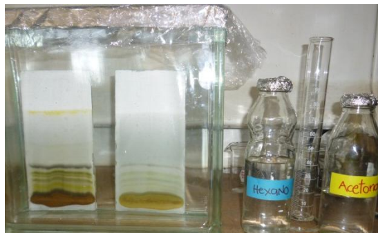
Figura 3.5. En la figura se muestra el corrido ascendente de placas cromatográficas en un tanque sellado.
