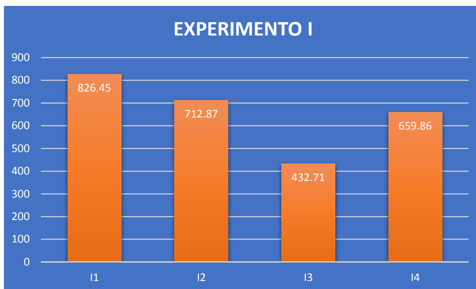
FIG 26. Ppm de Plomo en suelo Electrorremediado en una celda con un Voltaje de 40 por 24 hr., con un Amperaje de 2 y el Solvente utilizado fue agua destilada.
