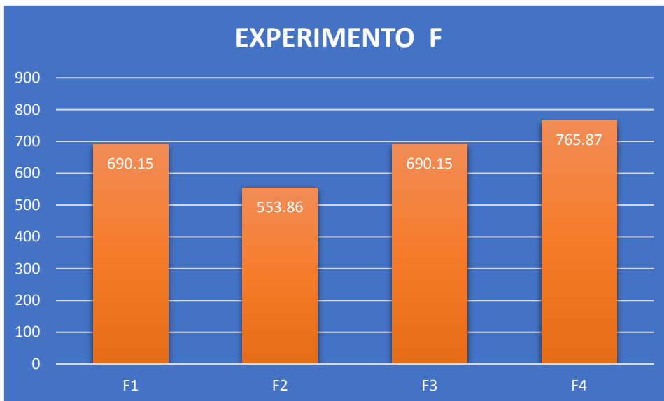
FIG 23. Ppm de Plomo en suelo Electrorremediado en una celda con un Voltaje de 20 por 24 hr., con un Amperaje de 2 y el Solvente utilizado fue Ácido Acético.
