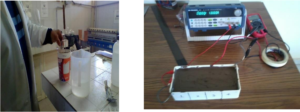
FIG 10. Contaminación y electrorremediación del suelo
