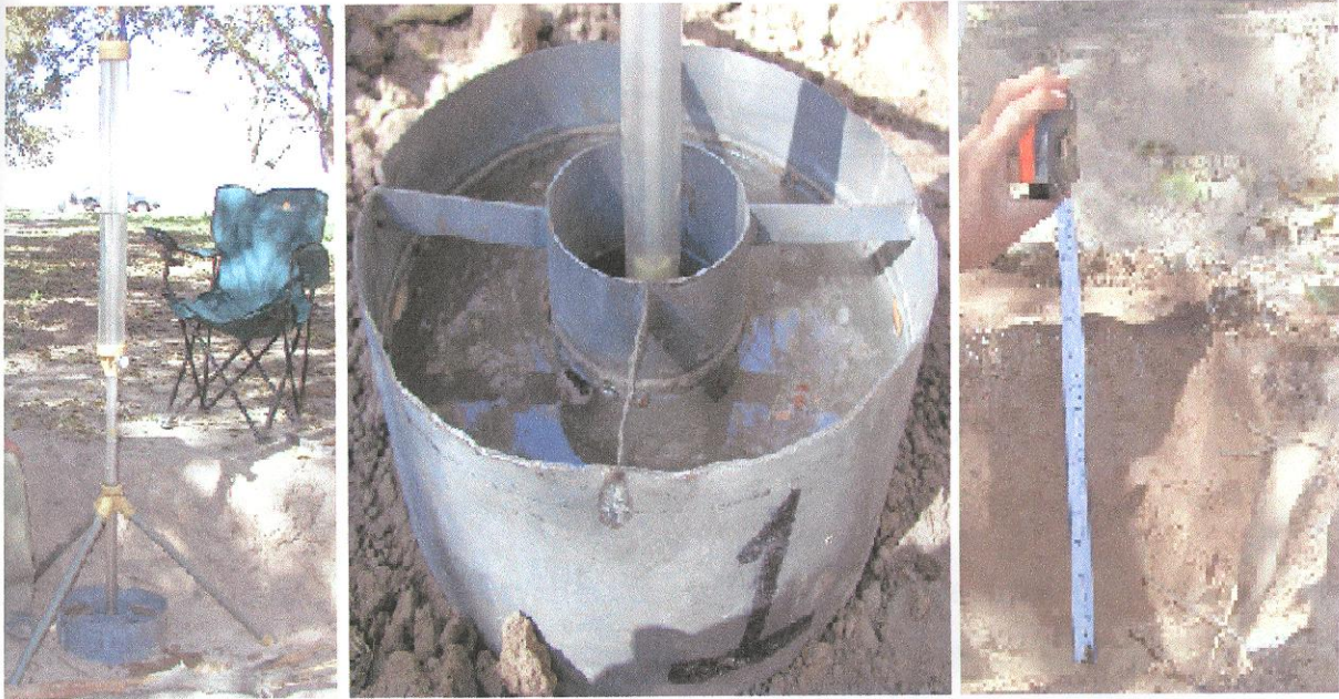
Figura 9. Método de Múntz modificado para medir permeabilidad.
