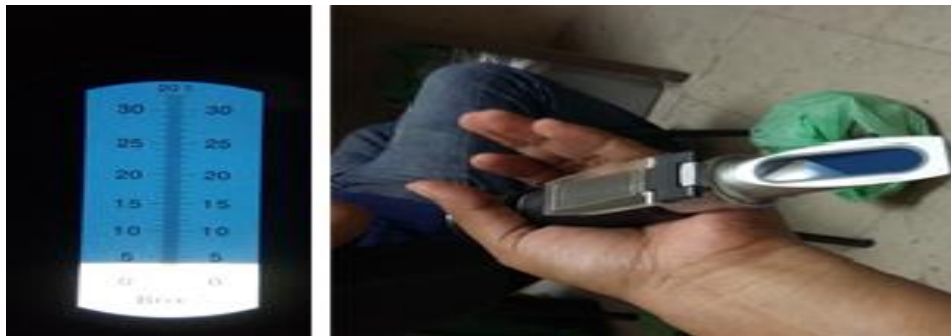
Figura 3.9 Lectura del contenido de solidos solubles obtenidos en la producción de la calabacita con la ayuda del refractómetro. UAAAN-UL, 2015.
