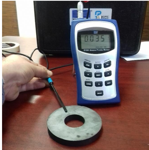
Figura 10. Medición del campo magnético real BM del iman de anillo cerámico o de ferrita.
