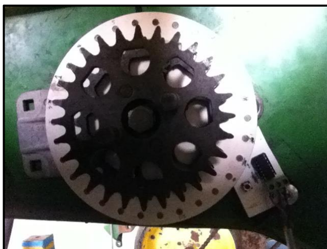
Figura 5.7 Sensor de semillas ideales.
