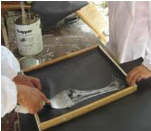
Figura 2 D. Colocación del adhesivo SEHU-TAK
