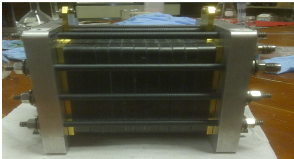
Figura 3.3. Stack de celda de combustible comercial con canales en paralelo [IER-UNAM].
