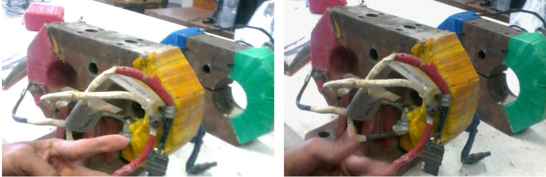
Figura 7 Transductor octagonal extendido amarillo-rojo ( F_x ) y verde-azul ( F_x )
