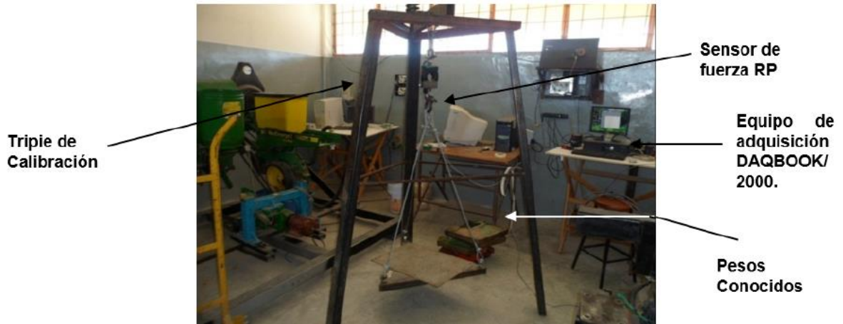
Figura 15 Calibración del sensor fuerza
