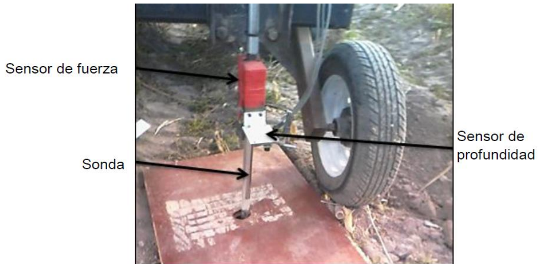
Figura 9 Penetrómetro digital
