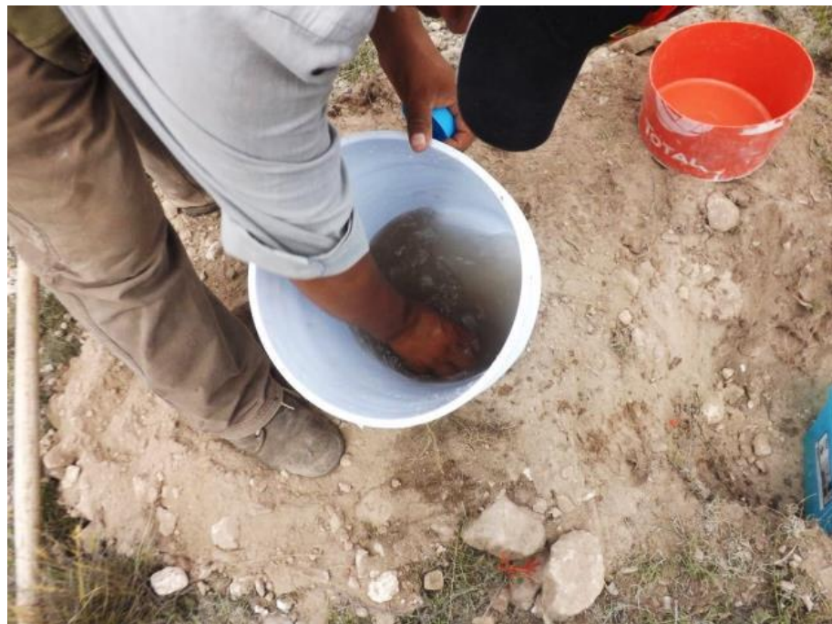
Figura 15. Recolección de la muestra de agua con sedimentos generados durante 30 minutos de lluvia simulada.
