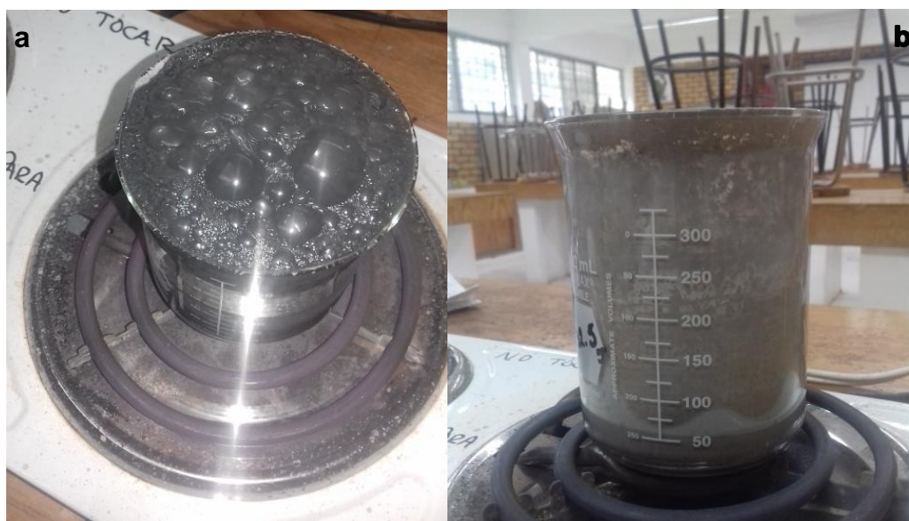
Figura 17. Inicio de la ebullición del agua que contiene la muestra de suelo (a); Término de la evaporación del agua al 100 % (b).
