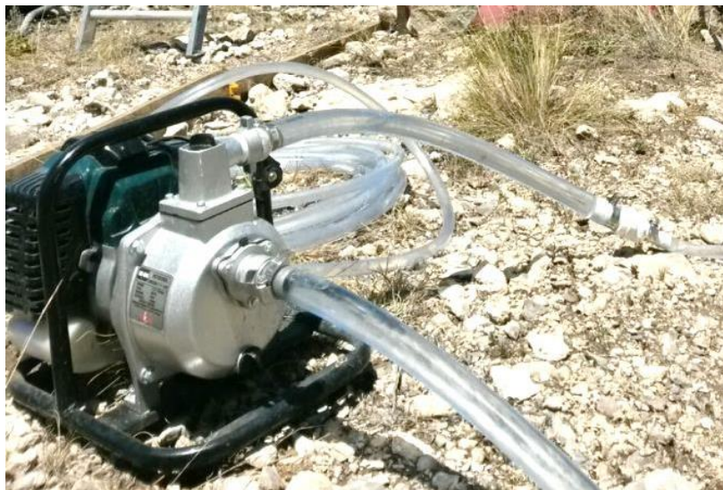
Figura 10. Conexión del contenedor de agua a la Motobomba, y de esta al simulador.
