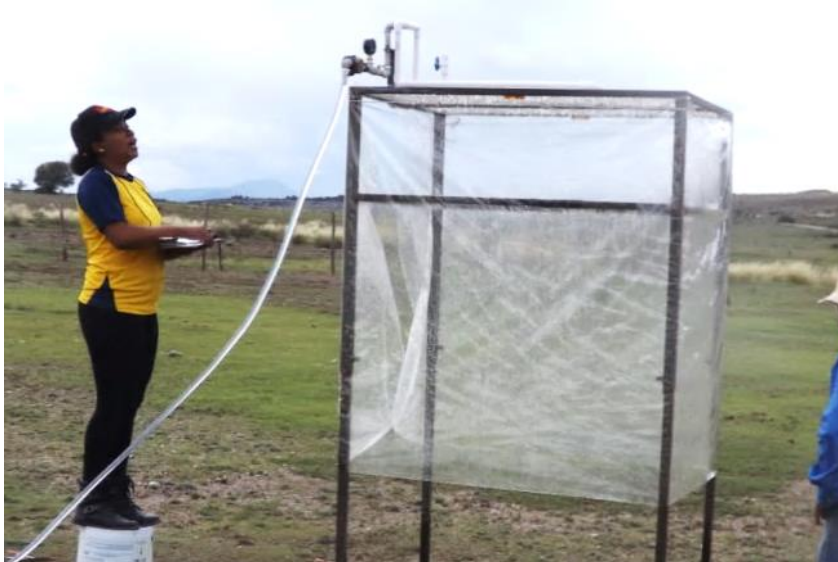
Figura 12. Registro de la cantidad de agua inyectada al panel del simulador.
