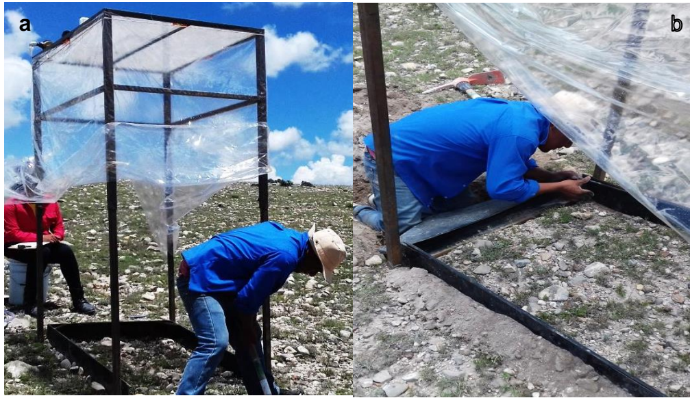
Figura 6. Colocación del simulador en función de la pendiente predominante (a); Colocación del bastidor (b).
