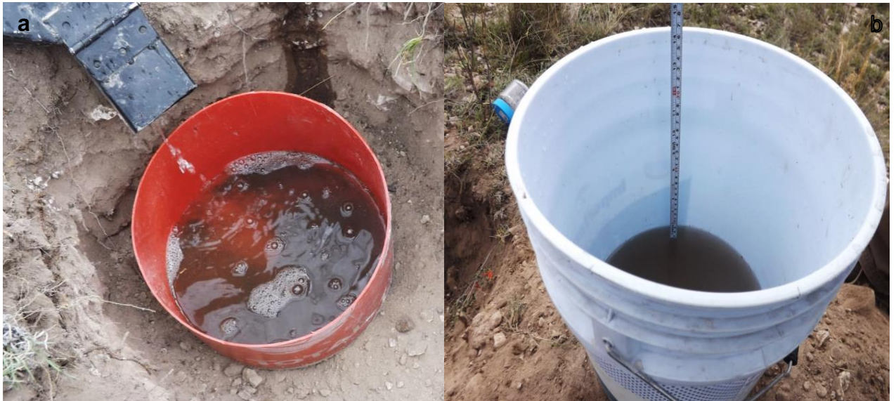
Figura 14. Recolección del escurrimiento de agua de 30 minutos de simulación (a); Medición del agua recolectada de 30 minutos de simulación (b).
