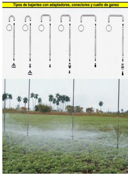
Figura 11. Manguera para colgante y tipos de colgantes.
