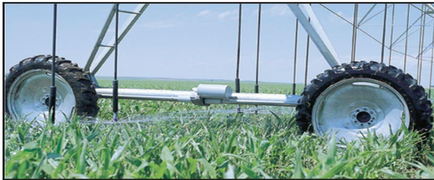
Figura 21. Sistema de propulsión neumática.
