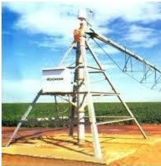
Figura 4. Centro pivote (soporte de movimientos bruscos).
