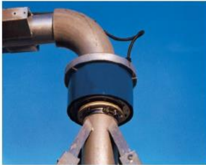
Figura 6. Anillo que permite el (giro y porta corriente).
