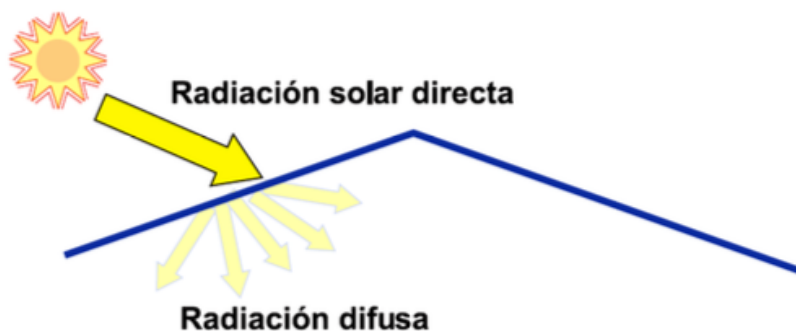
Figura 4. Efecto de difusión de una película plástica (Fuente: Hernández, 2012)
