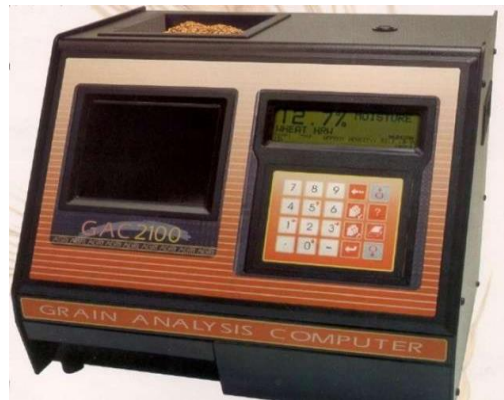
Figura 7 Aparato analizador de humedad y peso específico
