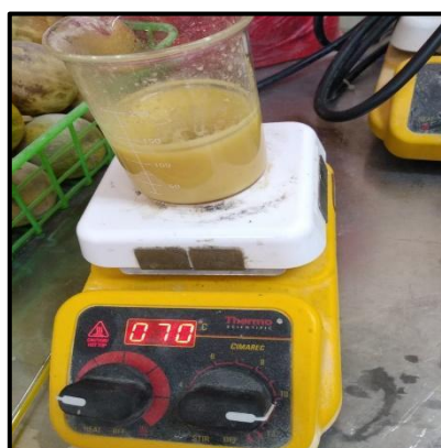
Figura 11. Muestra en contacto con Ac clorhídrico a 70 °C
