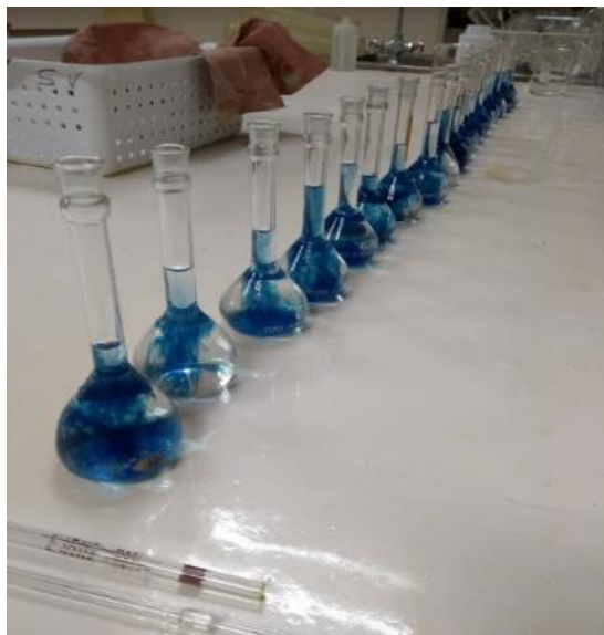
Ilustración 8. Determinación de fósforo por el método de colorimetría.
