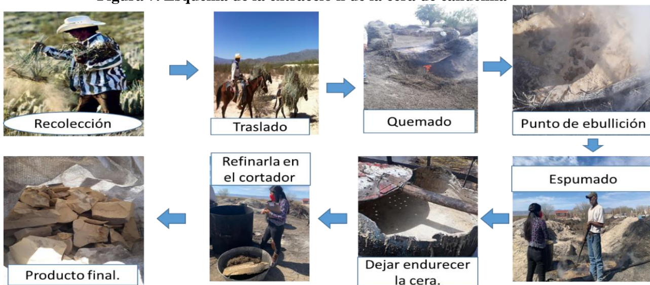
Figura 7. Esquema de la extracción de la cera de candelilla
