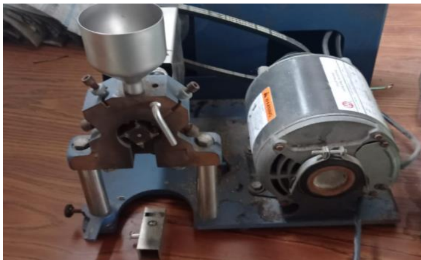
Figura 9. Molino ocupado para la molienda de las muestras de la marca Thomas Scientific® Laboratorio de suelos de la UAAAN U.L
