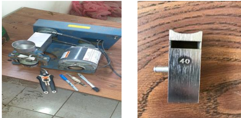
Figura 9. Molino y motor US ® que se utilizó para la molida de las muestras, junto con una criba del número 40.
