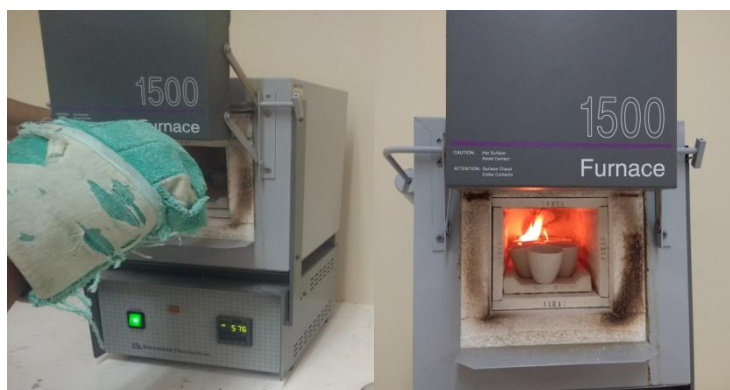
Figura 13: Calcinación de muestras en mufla Furnace 1500.
