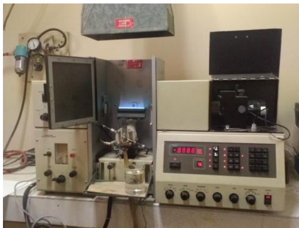
Figura 17: Espectrofotómetro de absorción atómica modelo Perkin- Elmer 2380.
