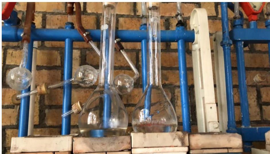
Figura 15. Matraz Kjeldahl preparado para la destilación
