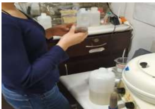
A6. Agitación del suelo con el agua azucarada de forma manual.
