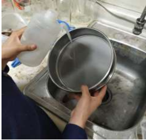
A7. Lavado paredes del tamiz con una pizeta con agua destilada.
