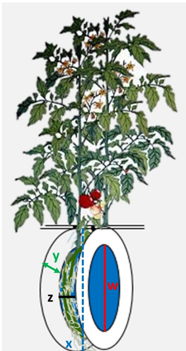
Figura 1. Esquema del carrete empleado en el sistema hidropónico: w: 60 cm (diámetro interno), x: 86 cm (diámetro externo), y: 15 cm (base del cilindro), z: 13 cm (profundidad de la ceja).
