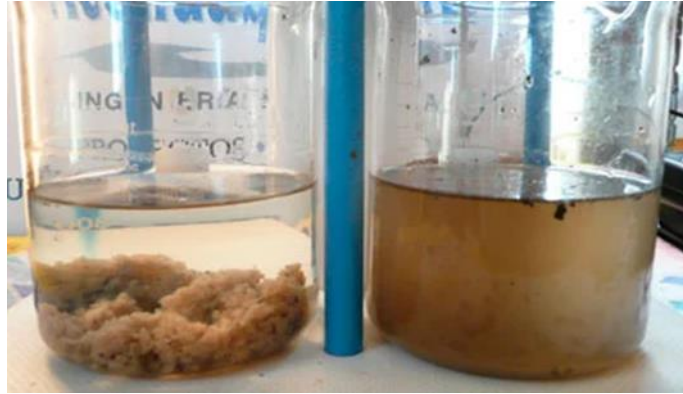
Figura 6. Comparativa de una muestra de agua residual con flocculantes
