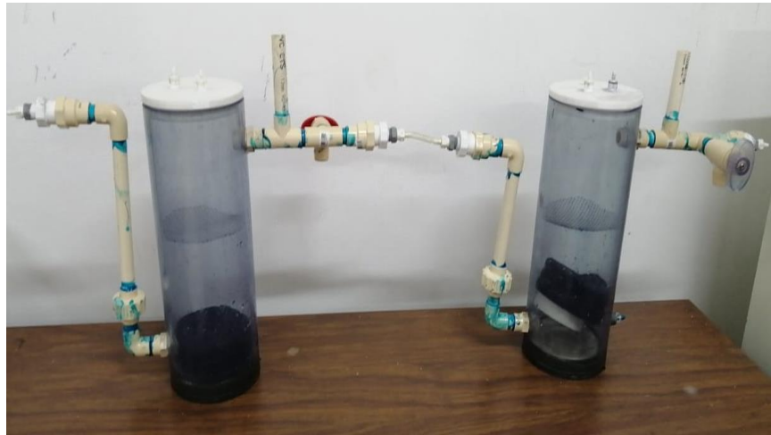
Figura 4. Sistema secuencial anaerobio-aerobio utilizado durante la investigación.
