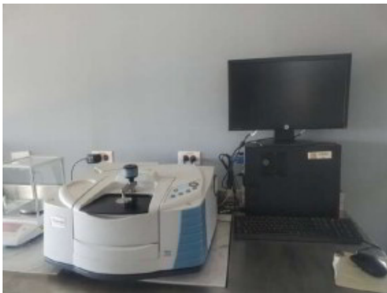
Figura 12. Equipo Nicole Is10 modelo Thermo Fisher Scientific usado para espectroscopía infrarroja por Transformada de Fourier (FTIR).
