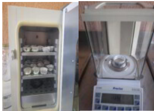
Figura 15. Secado de muestras húmedas (I), Pesado de muestras secas (II).
