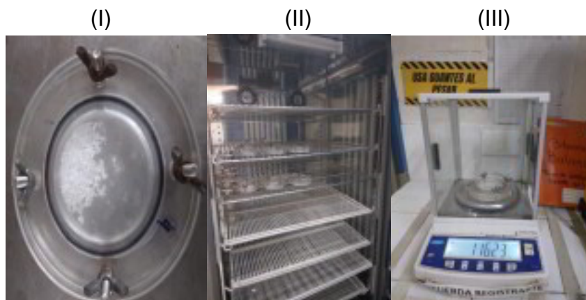
Figura 26. Muestras en celdas de permeabilidad (I), muestras en cámara climática (II), pesado de las muestras (III).
