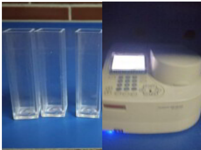
Figura 21. Muestras de BP colocadas en celdas (I), lectura de absorbancia de las muestras de BP (II).
