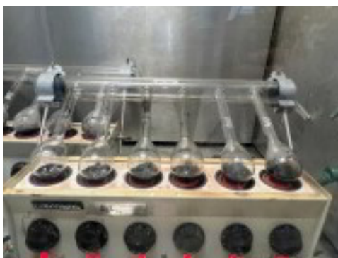
Figura 10. Muestra de mesquite y cardenche dentro del sistema extractor Soxhlet. (propiedad del autor)
