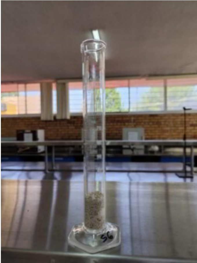
Figura 6 Zeolita NH_4 -clinoptilolita medido en base a volumen en una probeta de 100 ml
