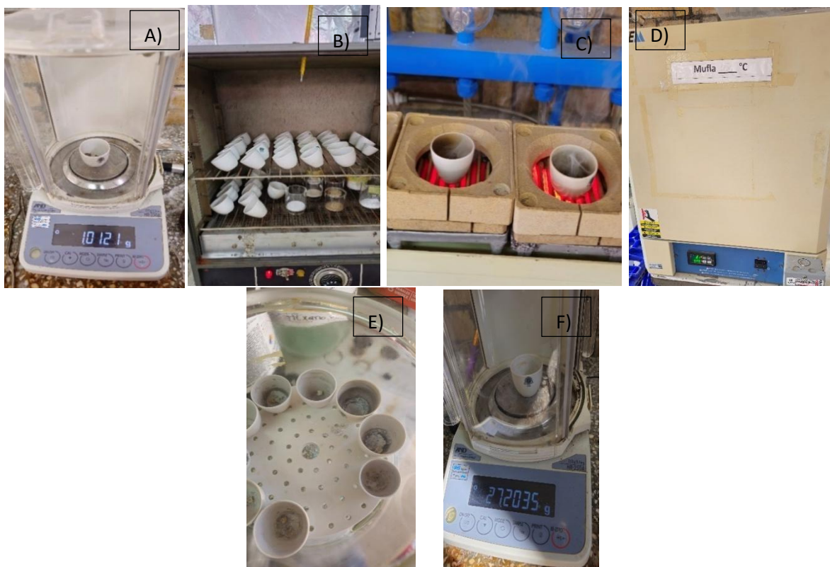
Figura 35. Determinación de materia seca y humedad. A) Peso de la muestra, B) Secado en la estufa durante 12hr, C) Pre-incineración de la muestra, D) Muestras en la mufla a 600°C, E) Muestras incineradas, F) Pesado la muestra una vez hecho cenizas.
