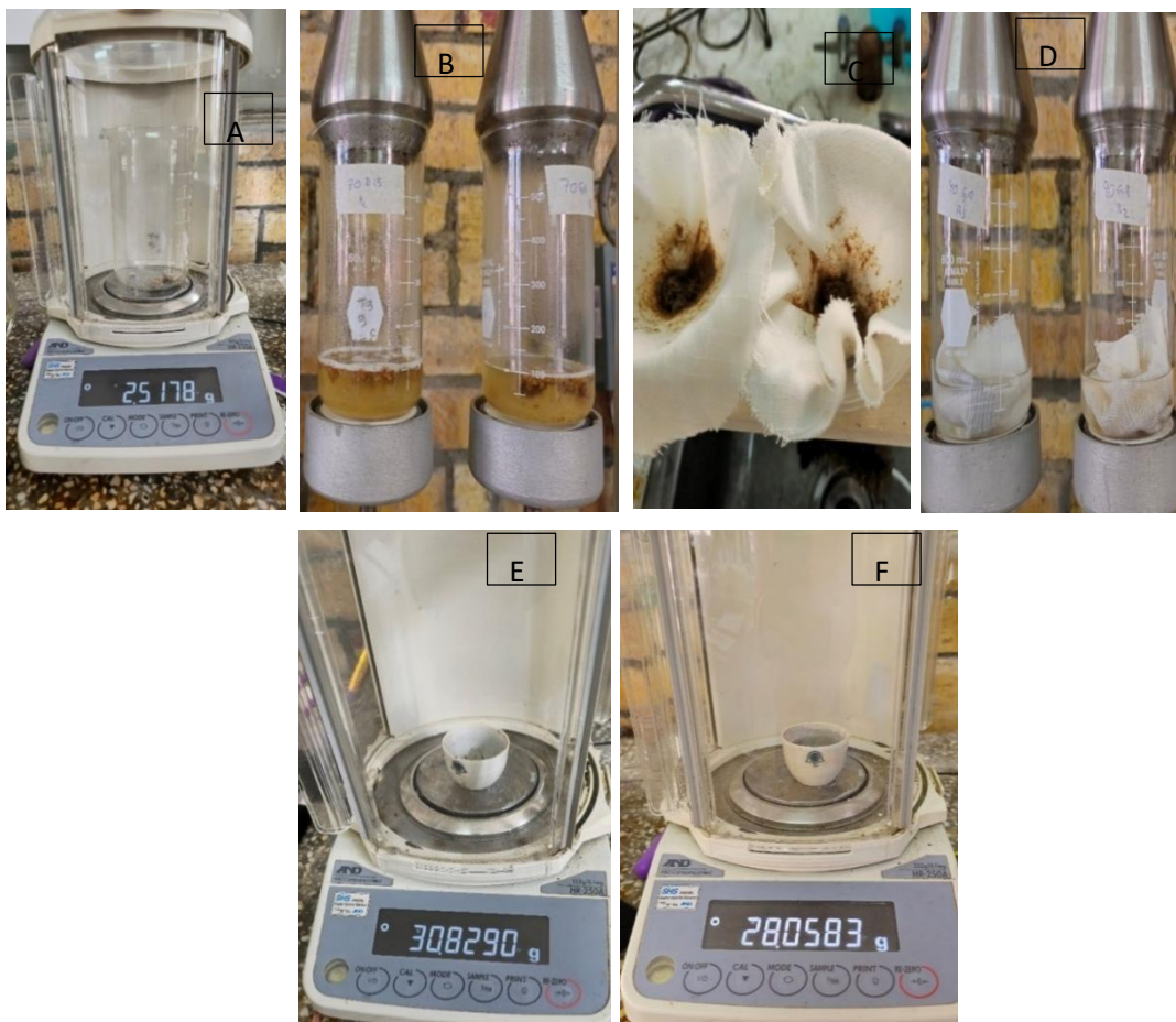
Figura 38. Determinación de fibra. A) Peso de la muestra, B) Instalación del vaso de Berzelius al equipo, con ácido sulfúrico, C) enjuague sobre tela filtro, D) se coloca nuevamente al equipo junto con la tela e hidróxido de sodio, E) Peso de la muestra previamente seca por 12hr, F) Peso de muestra en cenizas.
