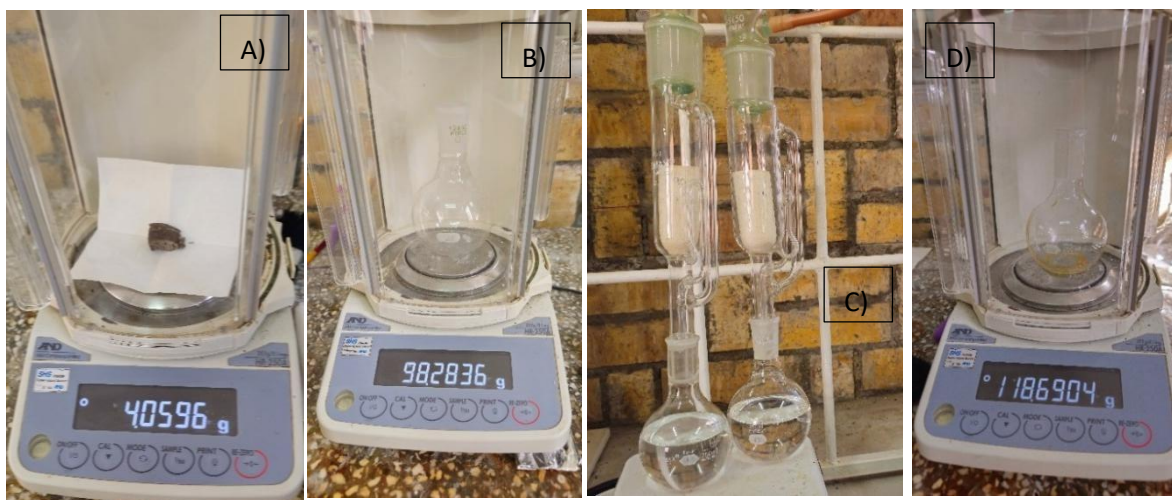
Figura 37. Determinación de lípidos. A) Peso de la muestra, B) Peso del matraz bola fondo plano, C) instalación al equipo soxhlet con hexano, D) peso del matraz con grasa.
