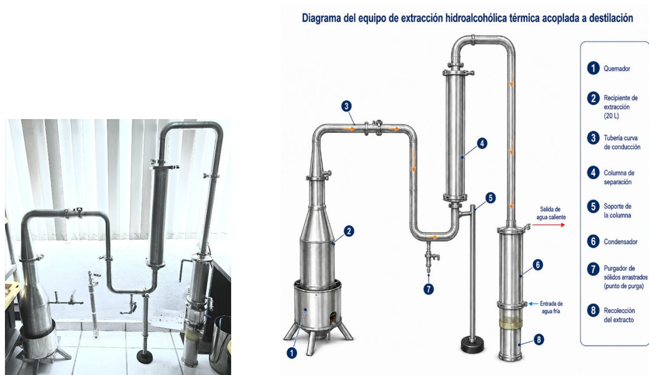
Figura 2. Equipo diseñado para la extracción hidroalcohólica térmica acoplada a destilación, utilizado para la obtención de extractos vegetales a partir de comino, pimienta negra y tomillo (Propiedad del autor).
