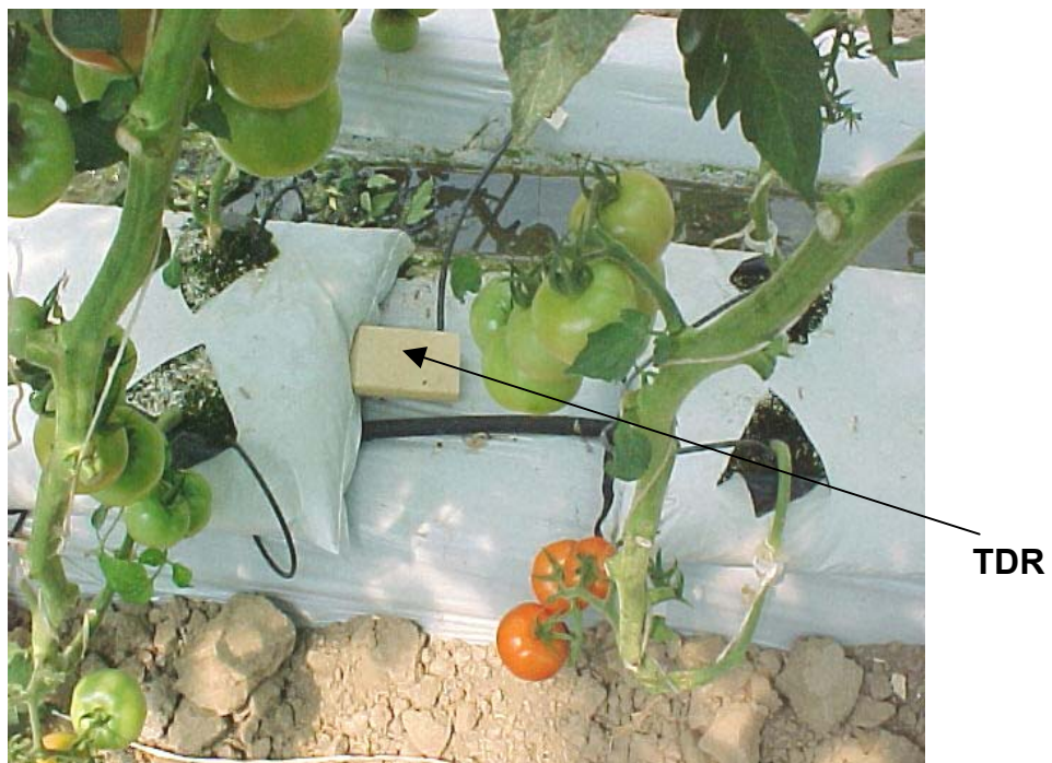
Fig. 3.6 Sensor TDR instalado en el taco con sustrato perlita.
