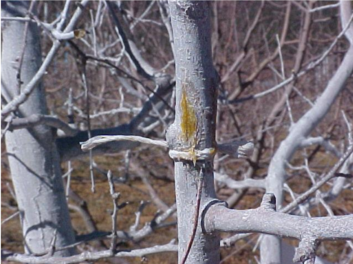
Figura 2. Inserción de termopares bajo la corteza de las ramas para medir su temperatura interna,
