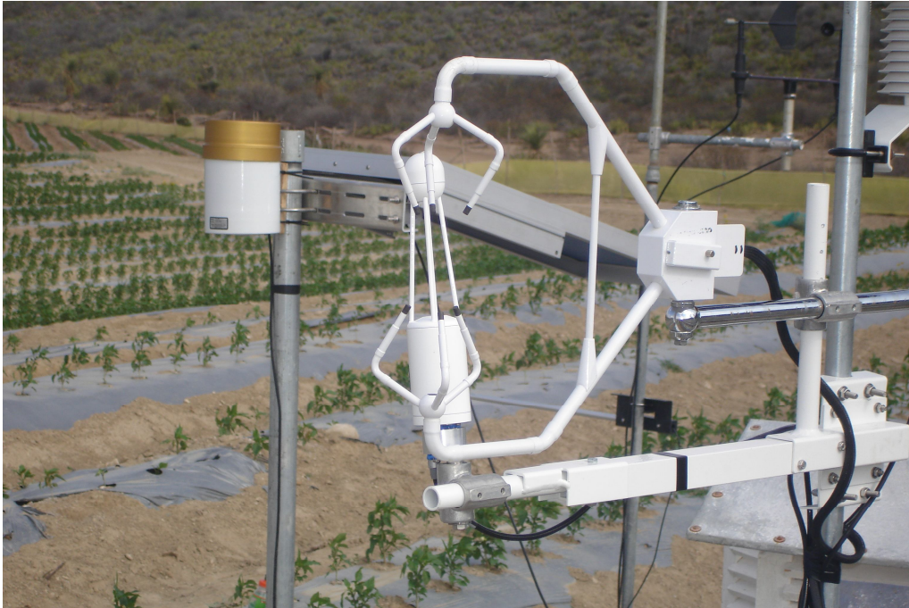
Figura 2. Sensores principales de un sistema eddy. 3-D sonic anemometer y CS7500 open path CO 2 /H 2 O gas analyzer.
