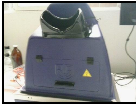
Figura 17: Transiluminador de luz UV con fotodocumentador.
