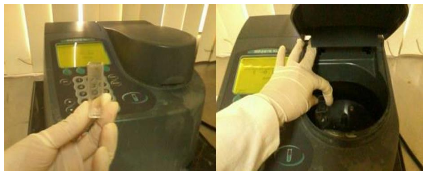
Figura 7. Medición de propiedades ópticas (Absorbancia)
