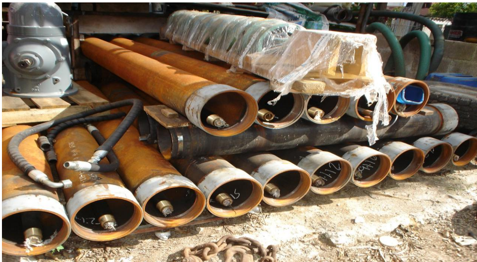
Tubos de Columna, Flechas y Bomba.
