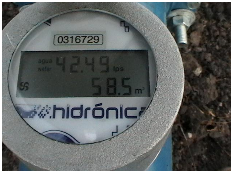
Medidor de Gasto instantáneo digital.
