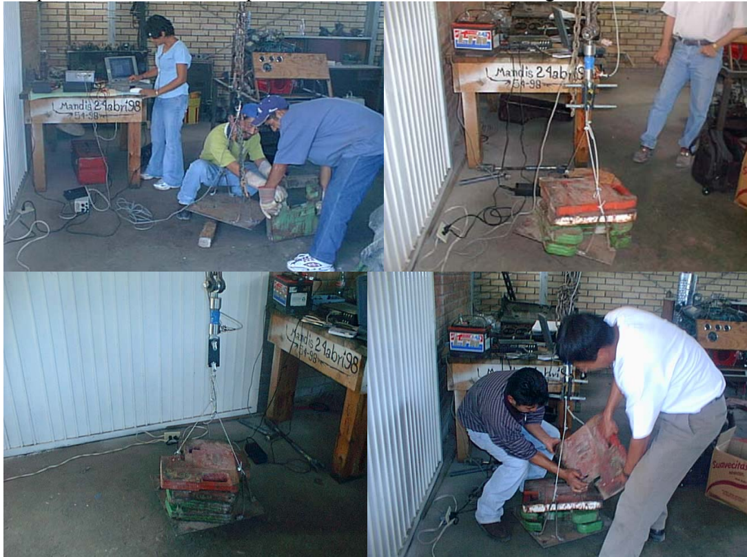
Figura 3.10. Carga y descarga de los contrapesos.
