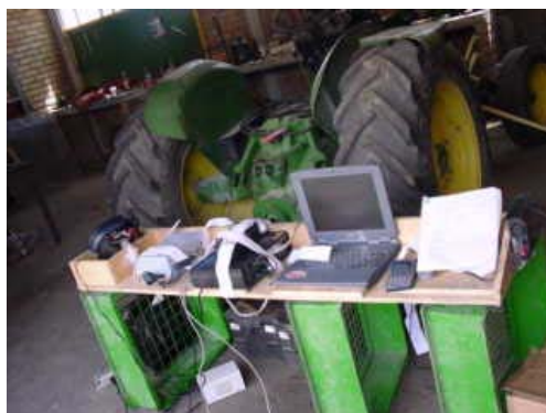
Figura 3.23 Instalación del equipo de adquisición de datos.
