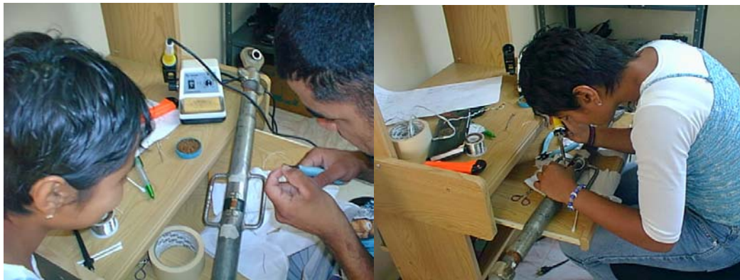
Figura 3.7. Colocación y soldadura de galgas.
