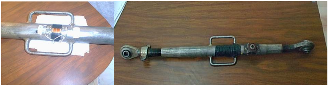
Figura 3.1. Transductor axial con montaje de galgas extensiométricas .
