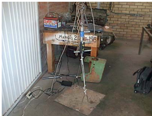
Figura 3.9 Colocación del transductor para la calibración.
