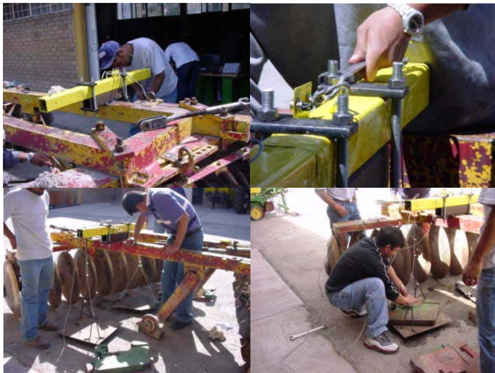
Figura 3.21 colocación de la barra sensora para la calibración.
