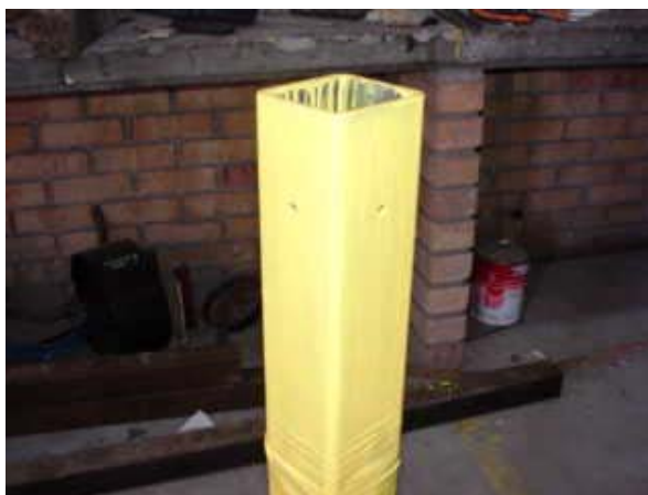
Figura 3.22 Perforaciones de la barra sensora.
