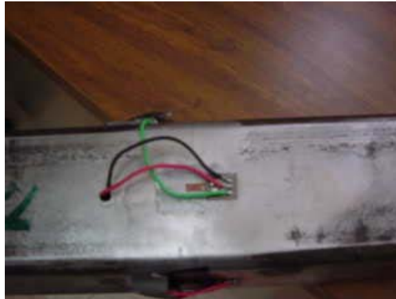
Figura 3.19 Colocación de las galgas en la barra sensora.
