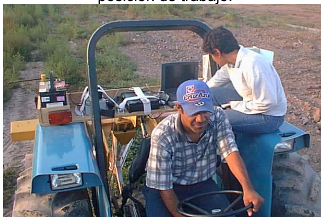
Figura 4.7. Sistema de adquisición de datos en campo.
