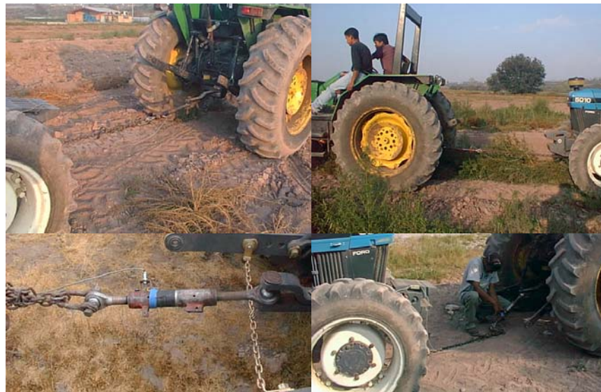
Figura 4.5. Conexión para la fuerza de tiro.
