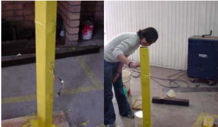
4.16. Construcción de la barra sensora del transductor de flexión.
