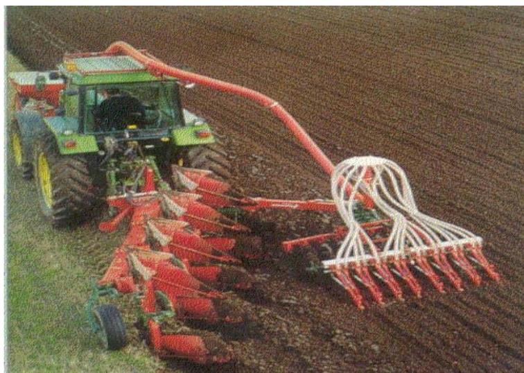
Figura 4.7. Labranza completa en una sola pasada.
