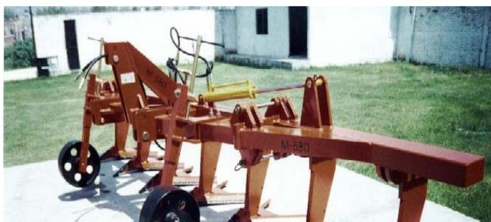
Figura 3.2. Multiarado hidráulico.
