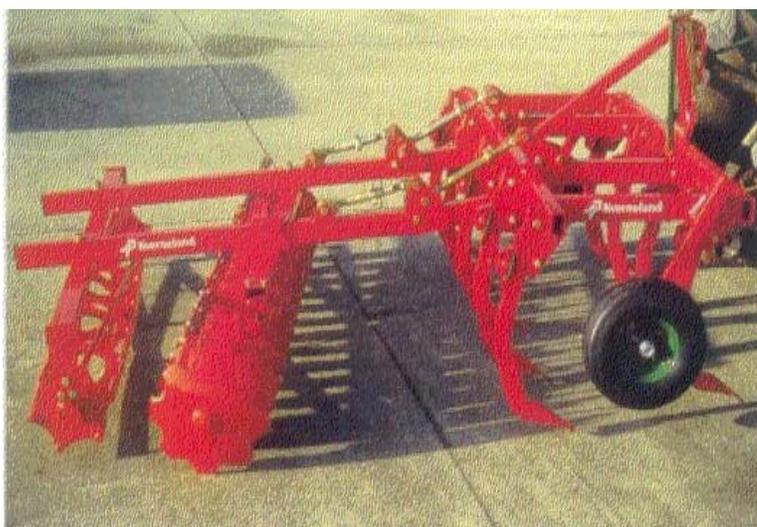
Figura 4.4. Implemento para reducir el tráfico del tractor.
