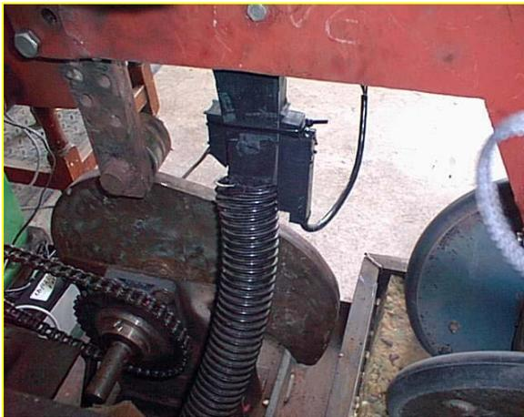
el sensor de semilla y el de desplazamiento. El contador está compuesto por dos microcontroladores COP8SA720N9, dos displays, cable plano de 14 guías y circuitos impresos (Figura 3.5); también, se requirió de una fuente de 12 Volts para conectar el contador.
