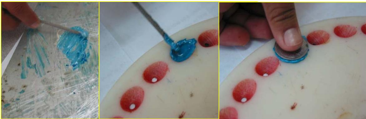
Fig. 3.13 Proceso para uniformar las celdas del plato dosificador de semilla.
