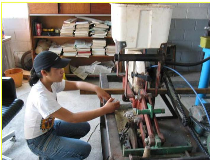
Figura 3.7 Pruebas para determinar el porcentaje de llenado de celdas
