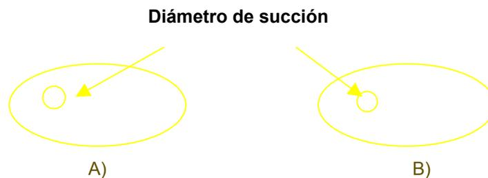
**Figura 3.8 Vista superior de la celda. Diámetro de succión A) 4.3 mm y B) 3.9 mm.**
