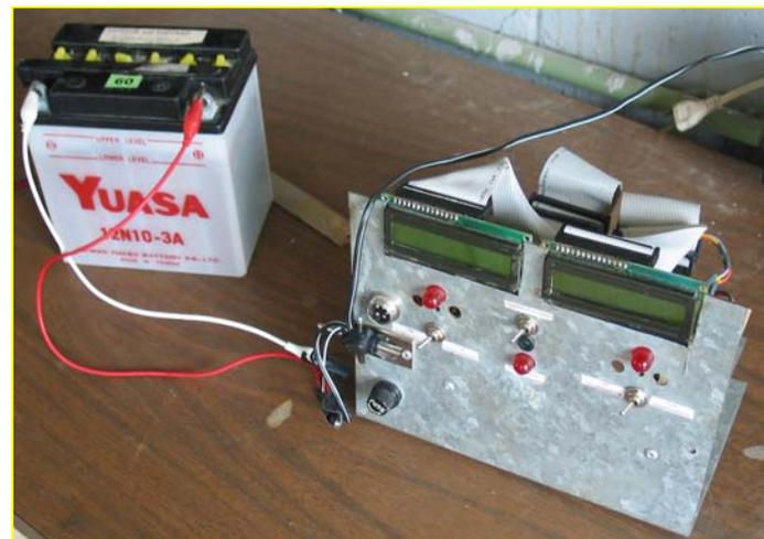
Figura 3.5 Contador digital conectado a la fuente de voltaje.
