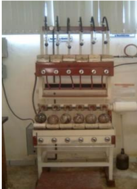
Figura 5.2. Aparato de Kjeldahl utilizado para digestión y destilación de la muestra de suelo para determinar nitrógeno
